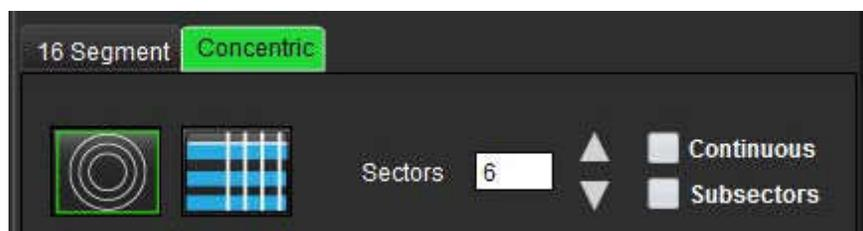
La pestaña Concéntrico proporciona los ajustes que cambian el formato del diagrama polar a un formato corte por corte, donde cada anillo representa un corte. El número de anillos está determinado por el número de cortes analizados.
